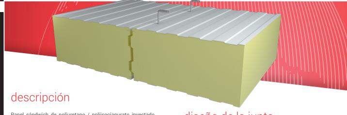
Panel sándwich de poliuretano / poliisocianurato inyectado, con junta seca machihembrada y sistema de cierre con **DOS GANCHOS** excéntricos de acero galvanizado, lo que garantiza un gran ahorro energético.
